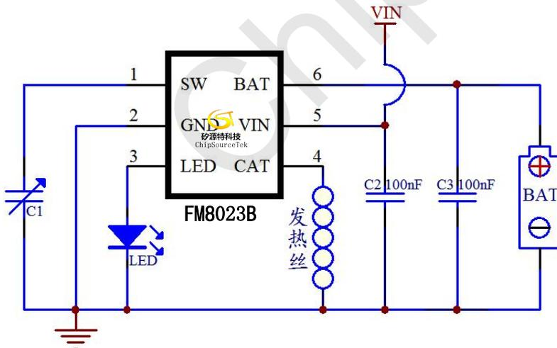
FM8023B 内部集成稳压管和功率管，无需外挂 MOS，外围应用电路简单，加工方便，降低损耗，系统成本低；芯片采用 DFN-6(3\*2\*0.85mm)封装,在封装体积较小的同时能够达到较好的散热效果。
