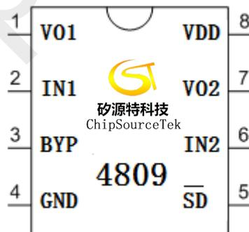
SOP8/MSOP8 管脚示意图
