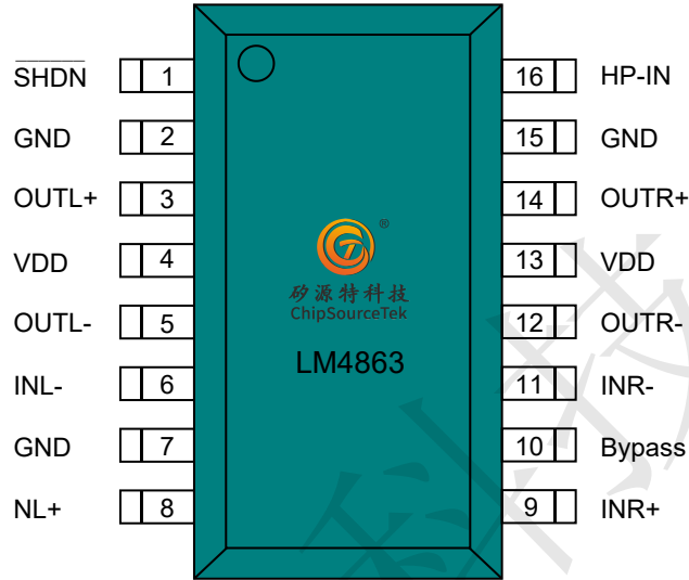
图2 LM4863引脚定义图
