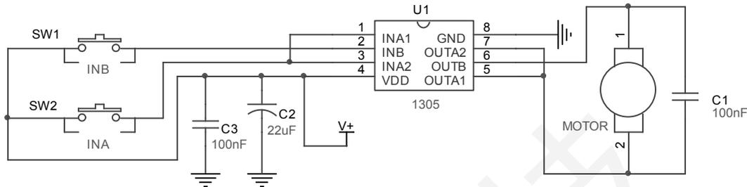
**注意：**图中 C1（100nF）电容为并接于马达上不是置于 PCB 板上。在不同的应用中，C2、C3 可考虑只装一个：在 3V 应用中建议用一个 1uF 或以上；在 4.5V 应用中建议用一个 4.7uF 或以上；在 6V 应用中建议用一个 22uF 或以上；均为使用贴片电容靠近 IC 之 VDD 管脚放置且电容的负极和 IC 的 GND 端之间的连线也需尽量短。即不要电容虽然近，但布线、走线却绕得很远。另外当使用大电解插件电容时，建议再按以上规则并一个 100nF。当应用板上有大电容在为其它芯片滤波时且离 TC1305 较远也需按如上要求再放置一个小电容于 TC1305 的 VDD 脚上。图中 C1 若不能焊在马达上，则将其设计在 PCB 上。
