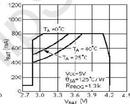
再充电电压门限与温度的关系曲线
