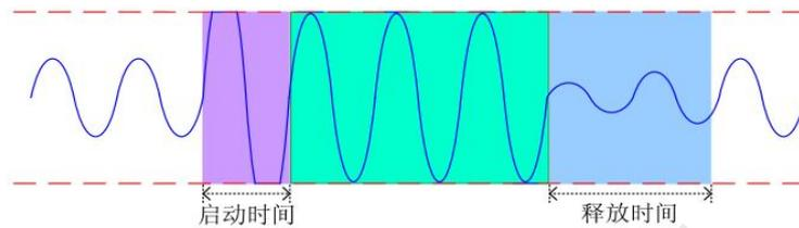
图 5 防失真工作模式下的音频输出信号
