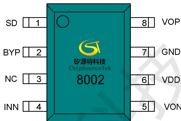
图 2 XYT8002D-OPA管脚定义
